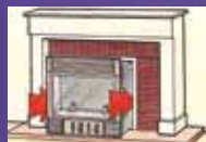
C Einbauen : Kamineinsatz an seinen Einbaort schieben, fertig
